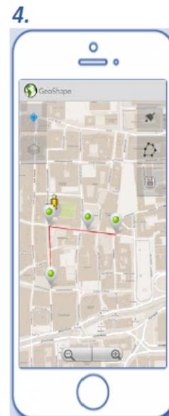
Erfassung der Lage im Kartenbild und aller Merkmale eines Streckenabschnitts, die erst am Ende erfasst werden können (Zustand der Oberfläche, Furten, Bordsteine u.a.).
