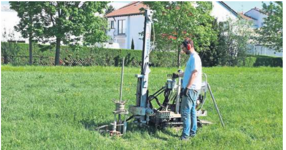
Im April fanden auf dem Grundstück an der Bühlstraße, wo das neue Fellbacher Feuerwehrhaus entstehen soll, Baugrunduntersuchungen statt. Foto: Knopp
